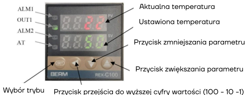
Rys. 7 - Przeznaczenie przycisków termostatu
