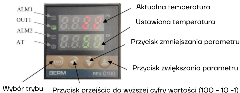
Rys. 7 - Przeznaczenie przycisków termostatu
