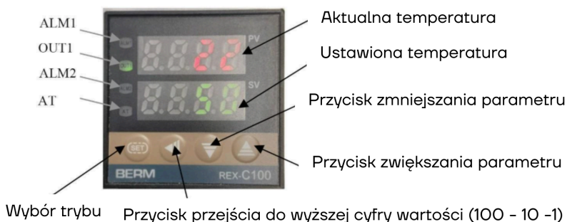
Rys. 7 - Przeznaczenie przycisków termostatu
