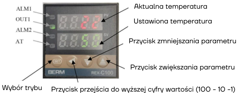
Rys. 7 - Przeznaczenie przycisków termostatu
