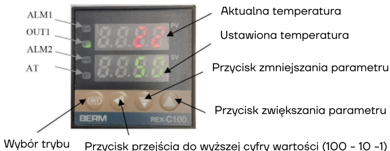
Rys. 7 – Funkcje przycisków regulatora temperatury REX C100
