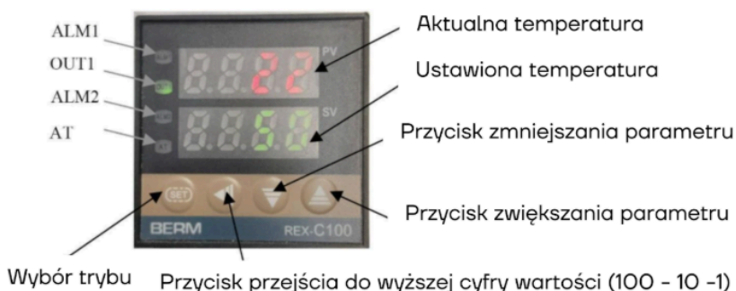
Rys. 7 – Funkcje przycisków regulatora temperatury REX C100
