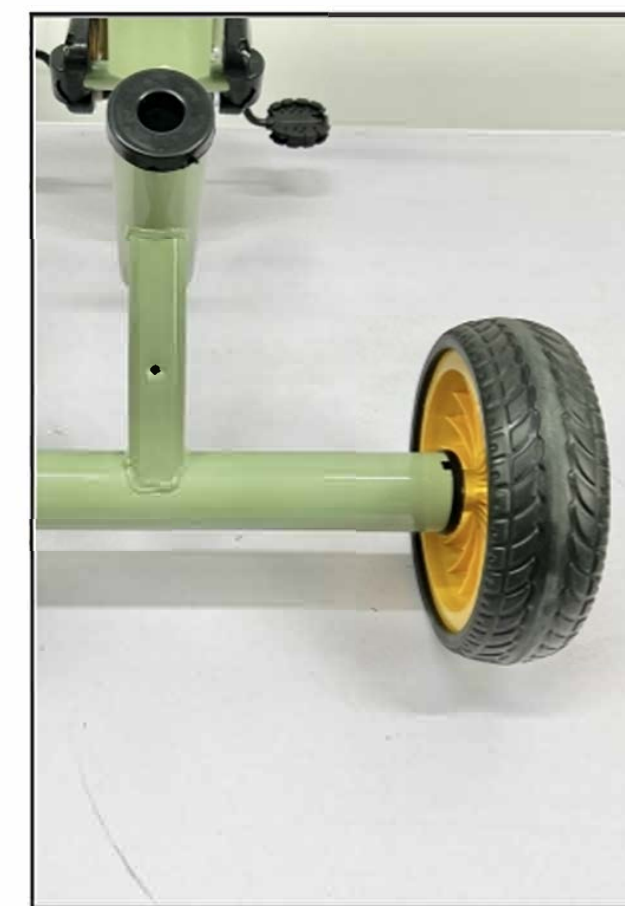
Montaż kół tylnych Installation of rear wheels
