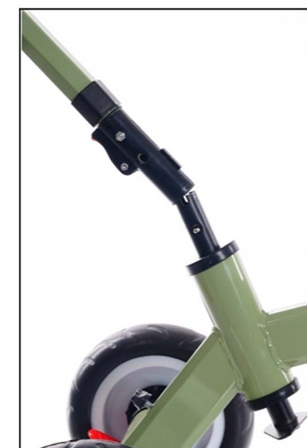
Rear push handle Mounted to steering rod Tylne uchwyty do pchania Zamontowany na drążku kierowniczym
